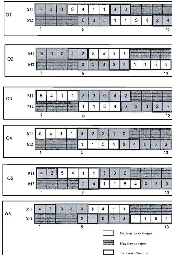
Figure 4-12: Les différents ordonnancements générés suite à la permutation des blocs
